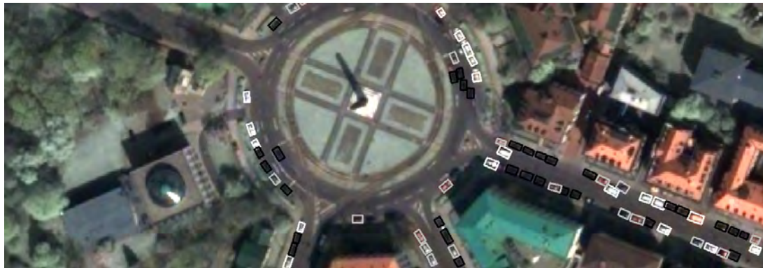
Abbildung 5.6: Referenzdaten für helle (weiße Umrandung), dunkle (schwarze Umrandung) und graue (graue Umrandung) Fahrzeuge.
